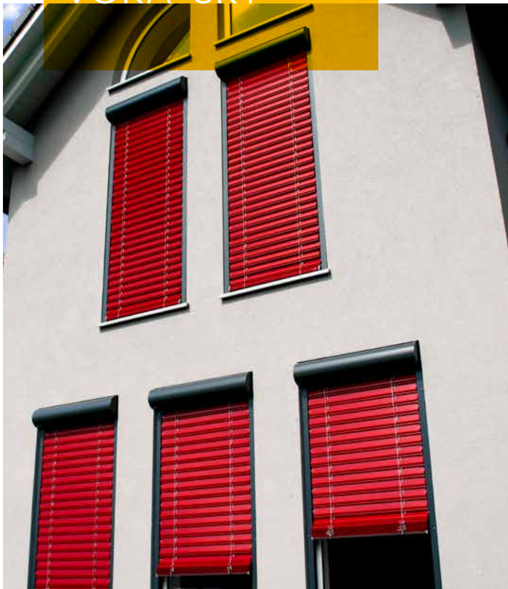
VOKA-SKY 120 Vorgesetzter, stranggepresster Rollladenkasten mit Raffstore-Lamellenbehang. Max. Breite 4000 mm Max. Höhe 4000 mm
